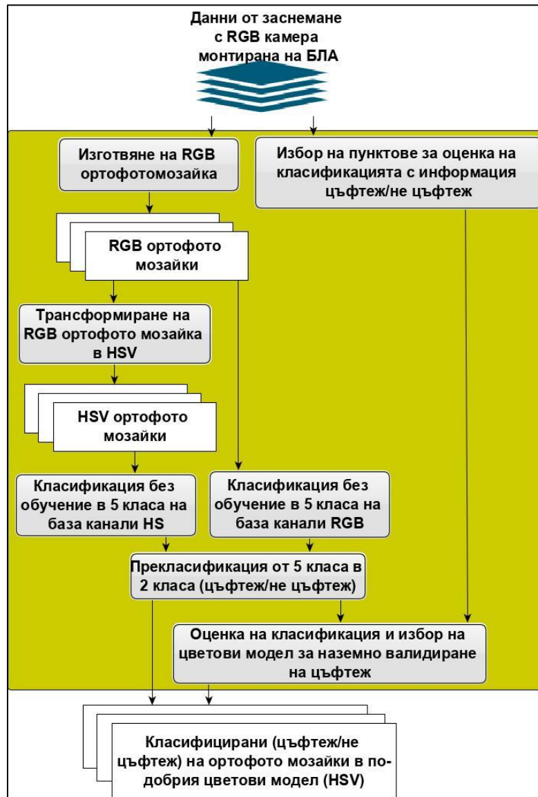
Фиг. 9. Структурна схема на разработената методика за избор на наземно валидиране за начало и край на цъфтеж на зимна рапица
