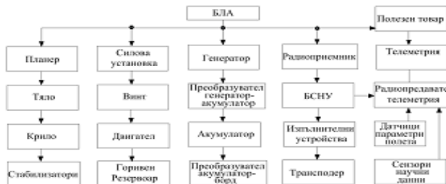
Фиг. 1 Бордна система за навигация и управление на БЛА-60.
