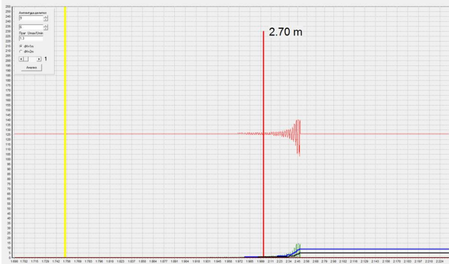
Фиг.3.3 Теоретичен отразен сигнал с многократна промяна на амплитудата
