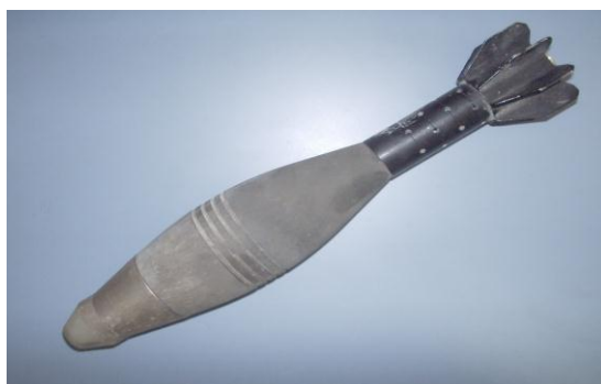
Фиг. 2.3 Мина с поставена сборка за запис
