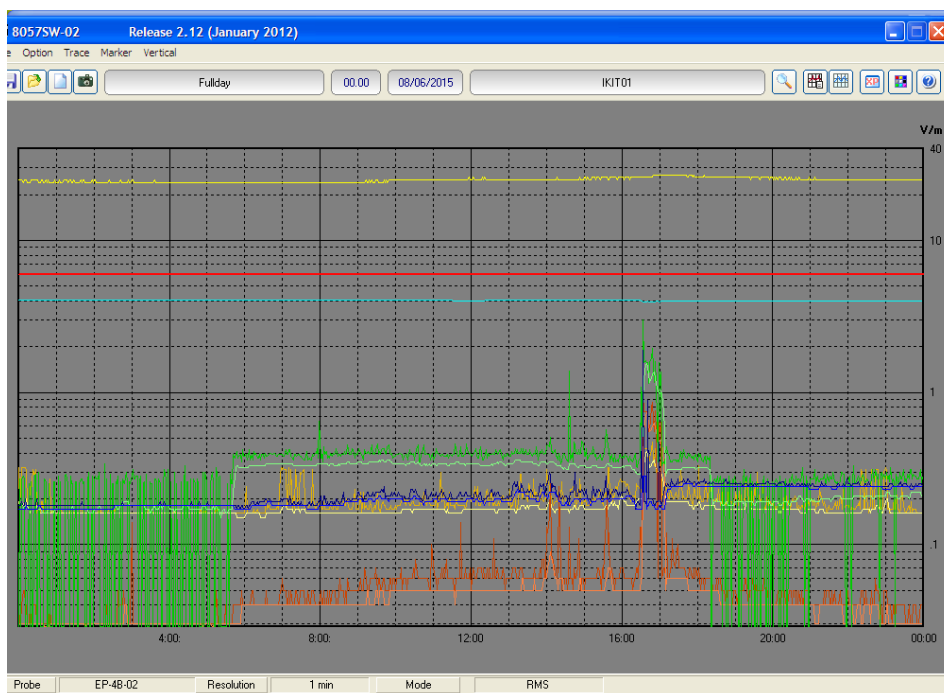
Фиг. 18. Резултатите от конкретните измервания за тази точка, снета от екрана на компютъра, показваща разпределението на интензивността на енергийния поток, за работни дни.
