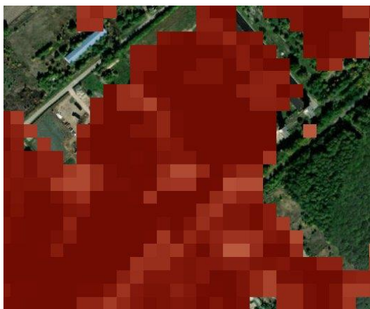
Фиг. 2.1. а) Слойт Степен на непроницаемост (IMD) в покрайнините на гр. Ген. Тошево, наложен върху ортофото.
