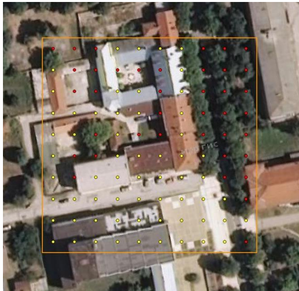
Фиг. 3.12 Измерване с равномерна мрежа 10x10 в населено място
