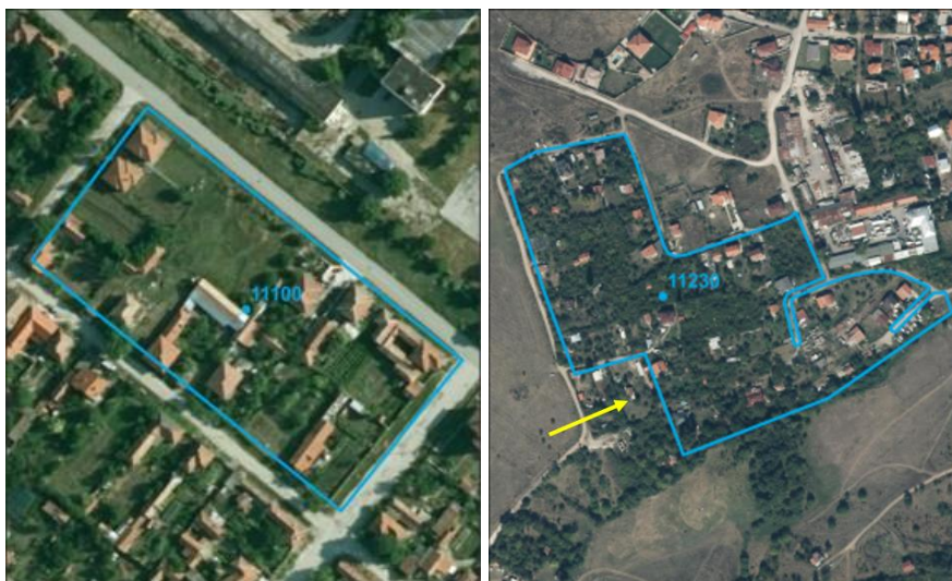
Фиг. 3.24. Клас 1.1.2.1 Discontinuous dense urban fabric (IMD 50% - 80%) погрешно класифициран като клас 1.1.1.0 Continuous urban fabric (IMD \geq 80%) (ляво изображение); Правилна класификация на клас 1.1.2.3 Непрекъснат урбанизирани структури с ниска плътност (S.L. 10% - 30%) със срещане на липсващи части - жълта стрелка (дясно изображение).
